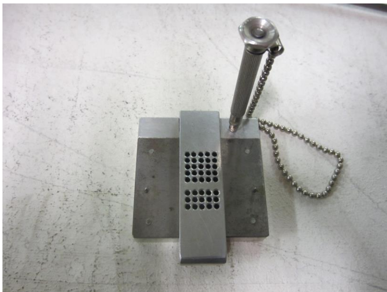
Tämäkin voisi olla mikätin: reikänauhan korjauslaite tietokoneen ohjelmointiin. (Kuva: RMM / Mikko Aho)
